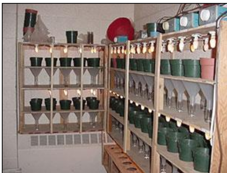
Figure 3-12. Entonnoirs de Berlese utilisés pour extraire des microarthropodes d'échantillons de sol non perturbés. Source : http://soilbugs.massey.ac.nz/collection_berlese.php
