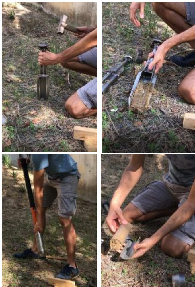
Figure 3-10. Échantillonnage du sol à l'aide de deux types de carottiers de section carrée (5 x 5 cm de côté) ou circulaire (5 cm de diamètre) de 15 cm de long. Les deux types de carottiers peuvent être ouverts dans le sens de la longueur pour obtenir des échantillons de sol non perturbés d'un volume constant connu.
